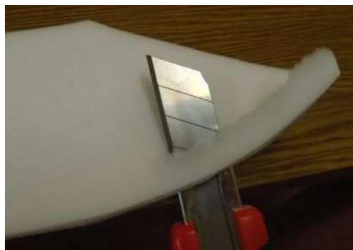
Boky lepíme na čepel seříznutou stranou. Rovná část se nám krásně zaoblí. Při lepení lepidlem nešetříme (první obrázek vpravo), ale lepidlo rozetřeme do souvislé vrstvy (druhý obrázek vpravo). Jinak by spoj brzy povolil a naše práce by přišla vničeč.
